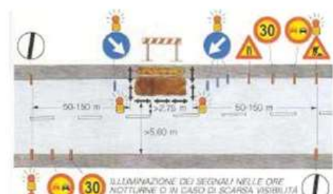
ILLUMINAZIONE DEI SEGNALE NELLE ORE NOTTURNE O IN CASO DI SCARSA VISIBILITÀ In questi casi il segnale "Lavori" e la barriera di testa delle zone di lavoro devono essere integrati con apparati luminosi di colore rosso a luce fissa e lo sfarfallamento continuo che precede eventualmente la zona di lavoro deve essere integrato con dispositivi a luce gialla lampeggiante.
